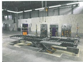
フレーム修正機
