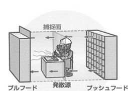
プッシュプル型換気装置の例
