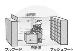
プッシュプル型換気装置の例
